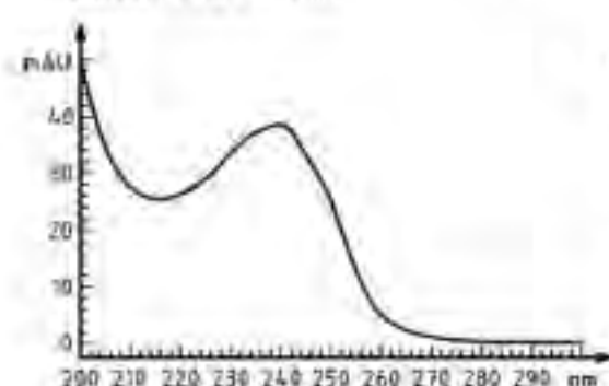
a) Espectro de absorción típico de MC-RR en un sistema de acetonitrilo/agua
