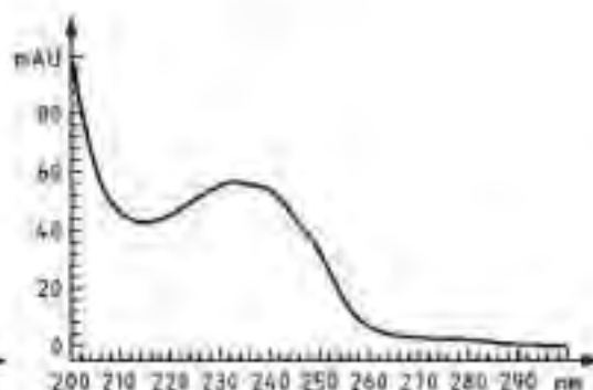
b) Espectro de absorción típico de MC-YR en un sistema de acetonitrilo/agua
